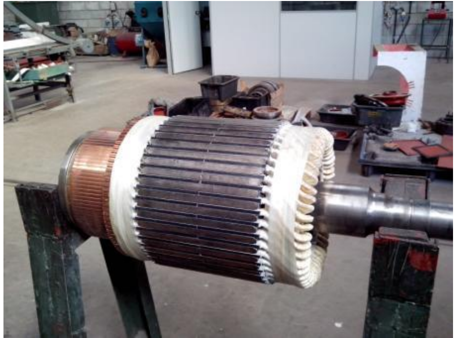
MOTOR GE 763 REBOBINAMENTO ARMADURA E CARÇA V&M.
