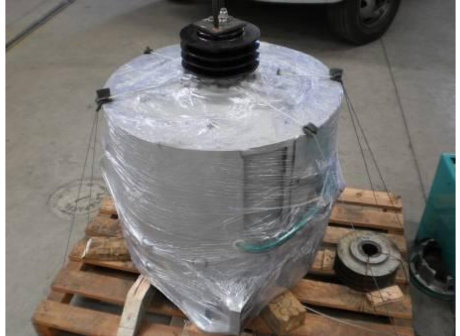
GERADOR PRINCIPAL LOCOMOTIVA GE MOD. GT558 / V&M
