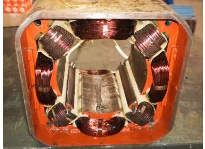
MOTOR WEG 70CV / BELGO BEKAERT
