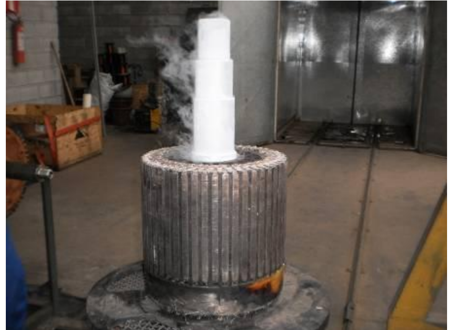
COLOCAÇÃO DE EIXO NOVO POR NITROGÊNIO / MOTOR GE 763 V&M
